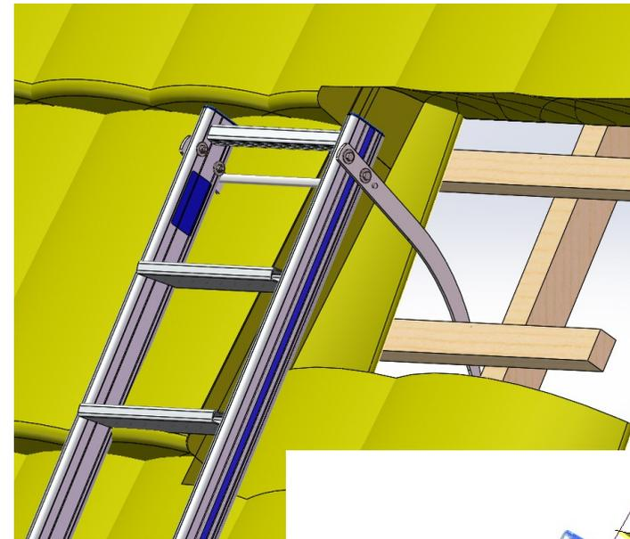
REETDACHSTUHL von sicheren Standplatz aus auf die gewünschte Arbeitshöhe auf das Dach aufbringen.
