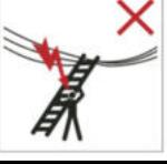
Warnung vor elektrischer Gefährdung bei der Montage und Benutzung der Leiter in der Nähe von Hochspannungs-Freileitungen
