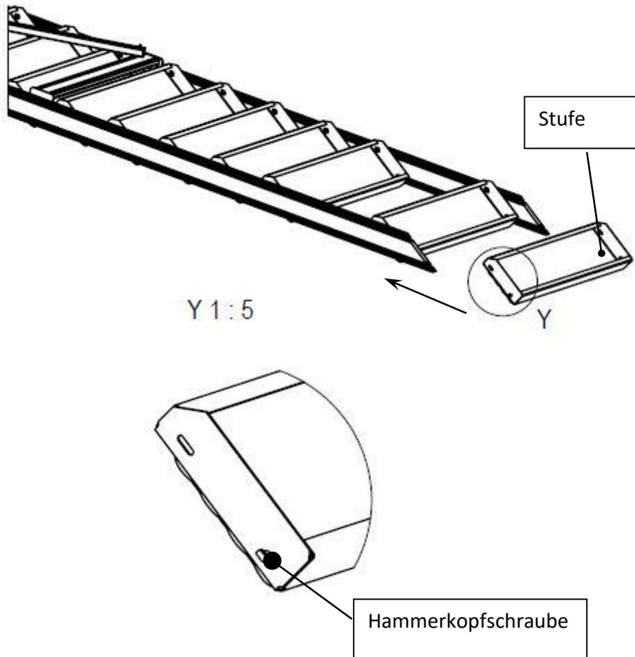
Bei diesem Schritt darauf achten die Hammerkopfschrauben nur in Bohrungen von der Stufe anzubringen damit die Stufen leichter verschoben werden können.
