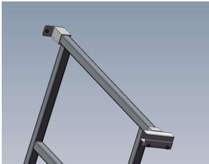
Abb. 58: Winkel zur Anbindung des stirnseitigen Geländers
